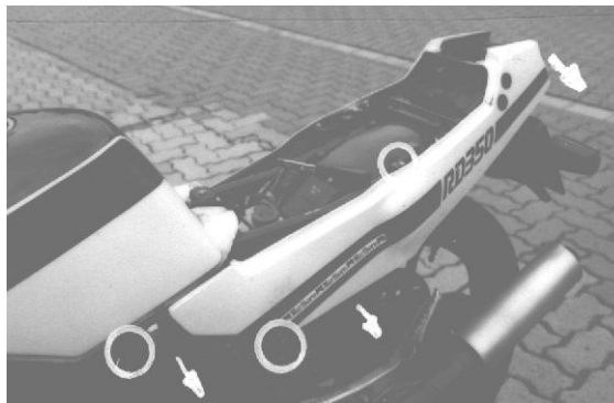
Bild 183: Abnehmen der Seitendeckel
