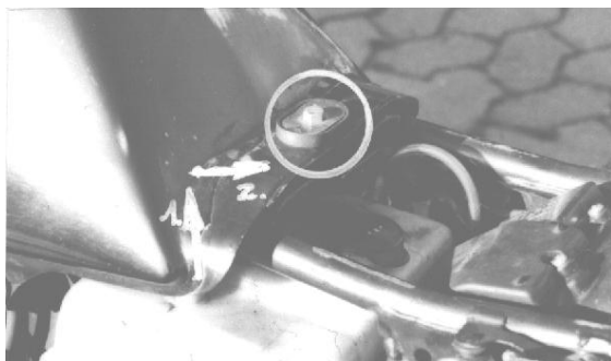
Bild 180: Tank abnehmen (31K)
