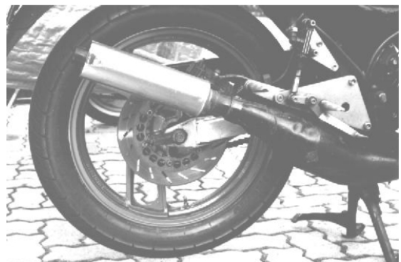
Bild 16: Schwinge 31K ('83-'84) (Auspuff und Felge 1WW)
