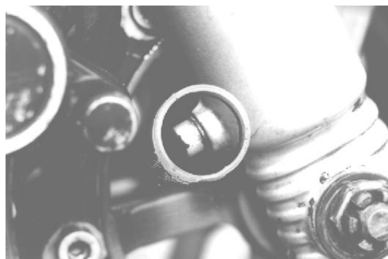
Bild 46: Ablassschraube Gabel (31K '83)
