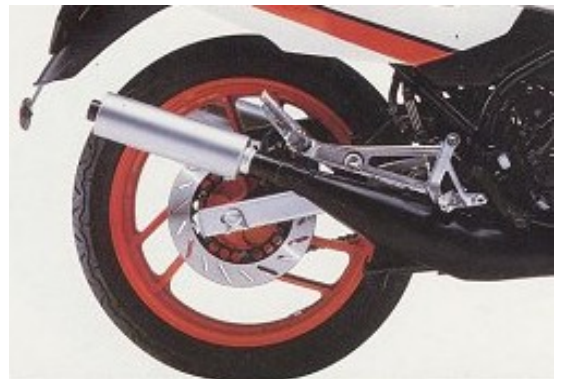
Bild 15: Schwinge 1WW (und 31K '85)
