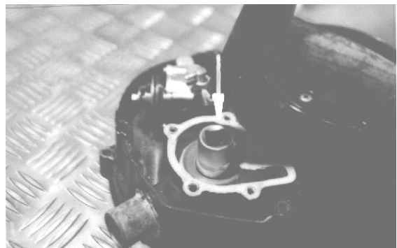
Bild 158: Austreiben des Dichtrings
