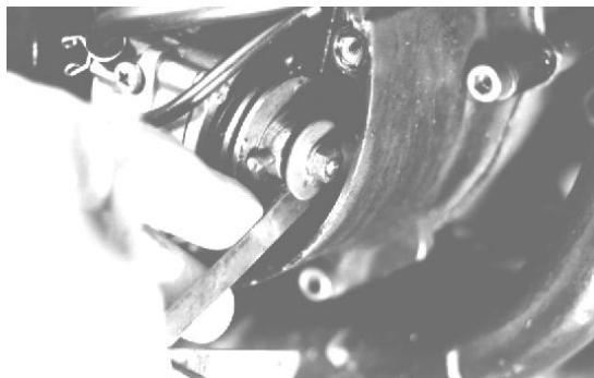
Bild 26: Messung des Mindestpumpenhubes
