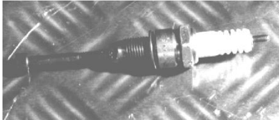
Bild 4: Kerze zur Kurbelwellenarretierung
