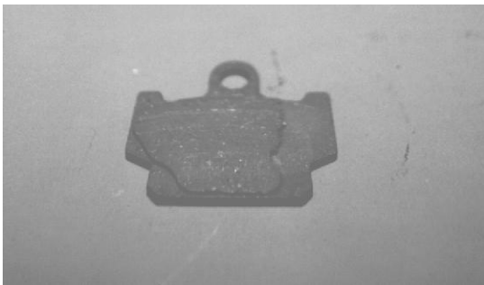
Bild 40: Bremsbelag 31K ('83-'84) (Dieser Belag hat offensichtlich seine maximale Lebensdauer erreicht!)
