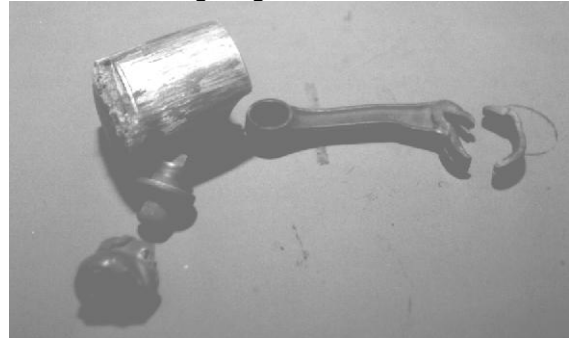
Bild 272: Zerlegtes Pleue mit Folgeschäden
