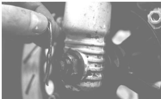
Bild 196: Kronenmutter mit Splint
