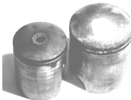
Bild 30: Kolbenschäden aufgrund zu warmer Zündkerze
