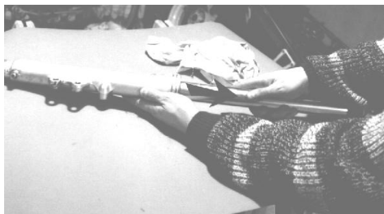
Bild 210: Obere Buchse austreiben
