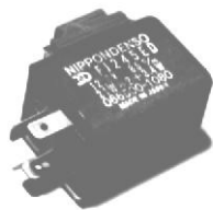
Bild 265: Stecker Blinkerausschalteinheit (In Deutschland nicht belegt!)
