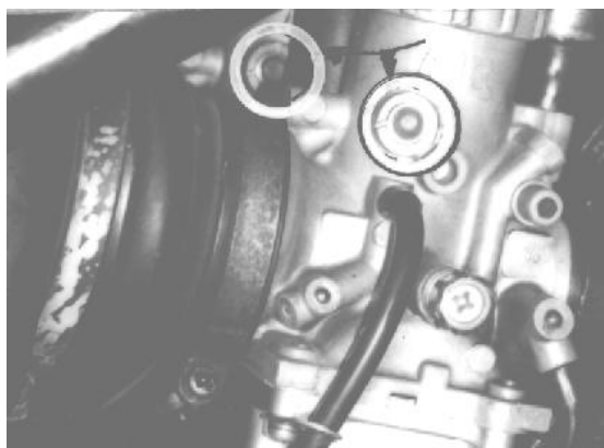
Bild 22: Schaugläser in den Vergasern
