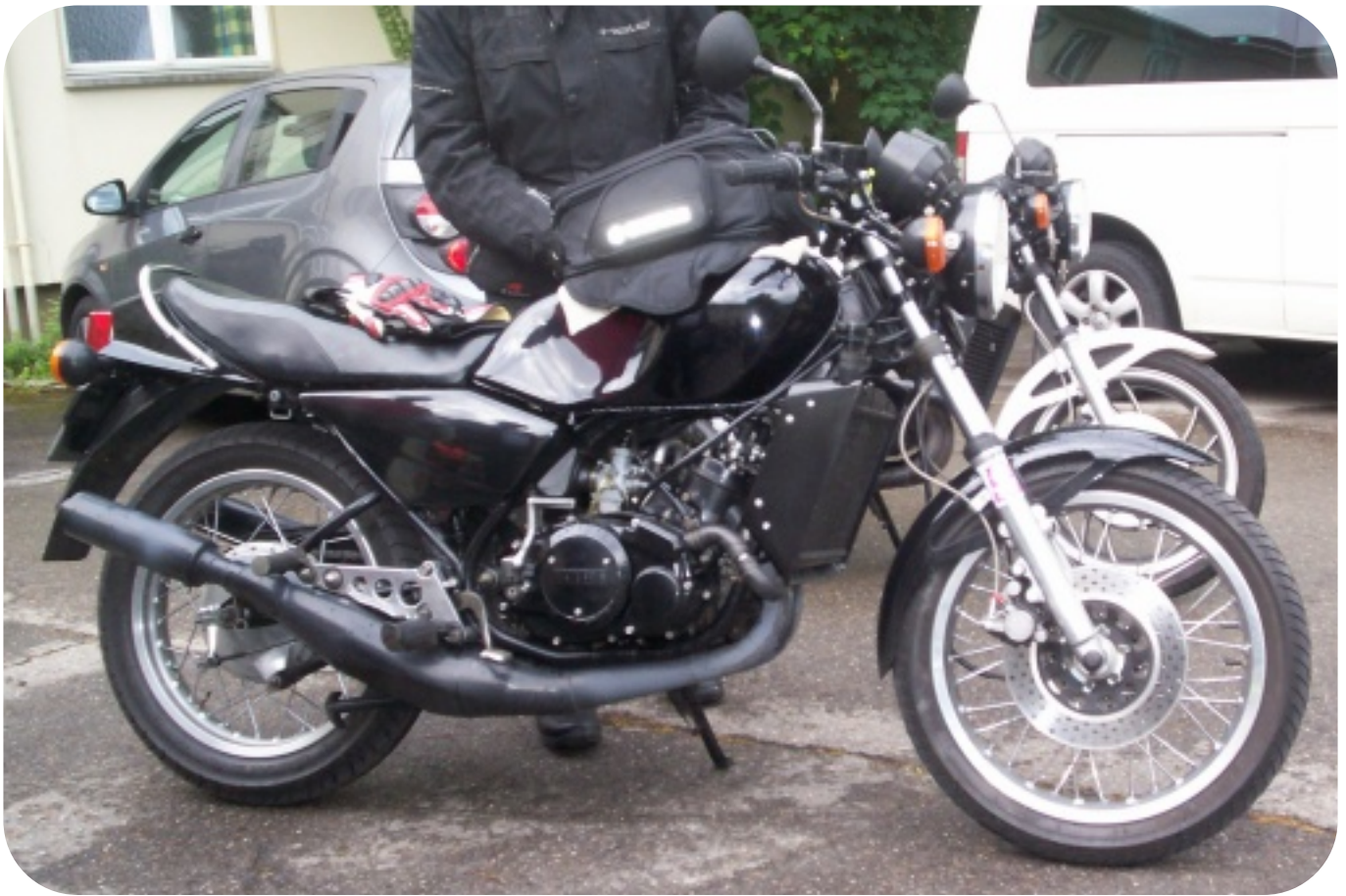
RD350LC (4L0). 31K-Motor mit Banshee-Zylindern. Speichenfelgen.
