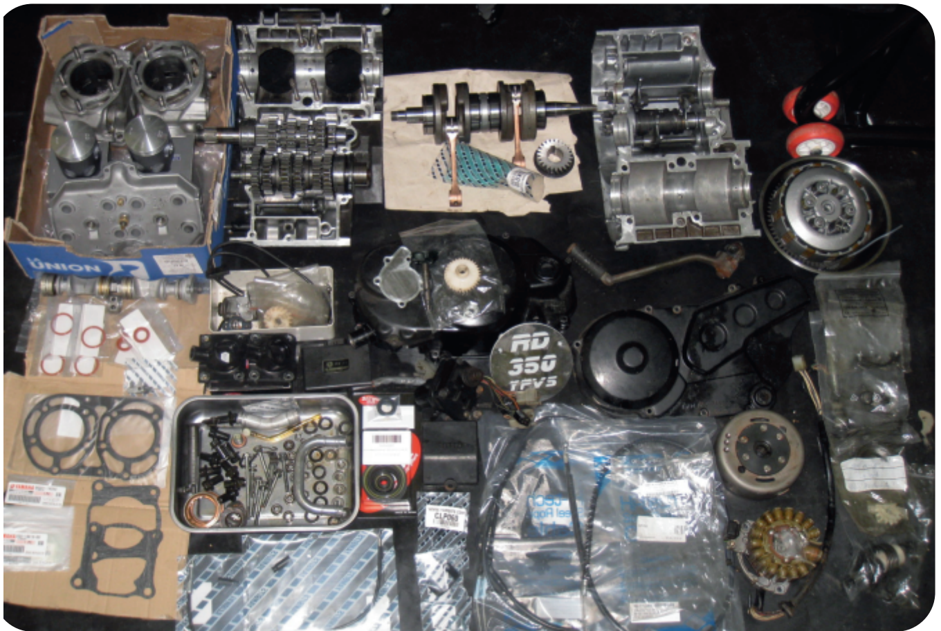
Motor einer RD350YPVS in Teilen
