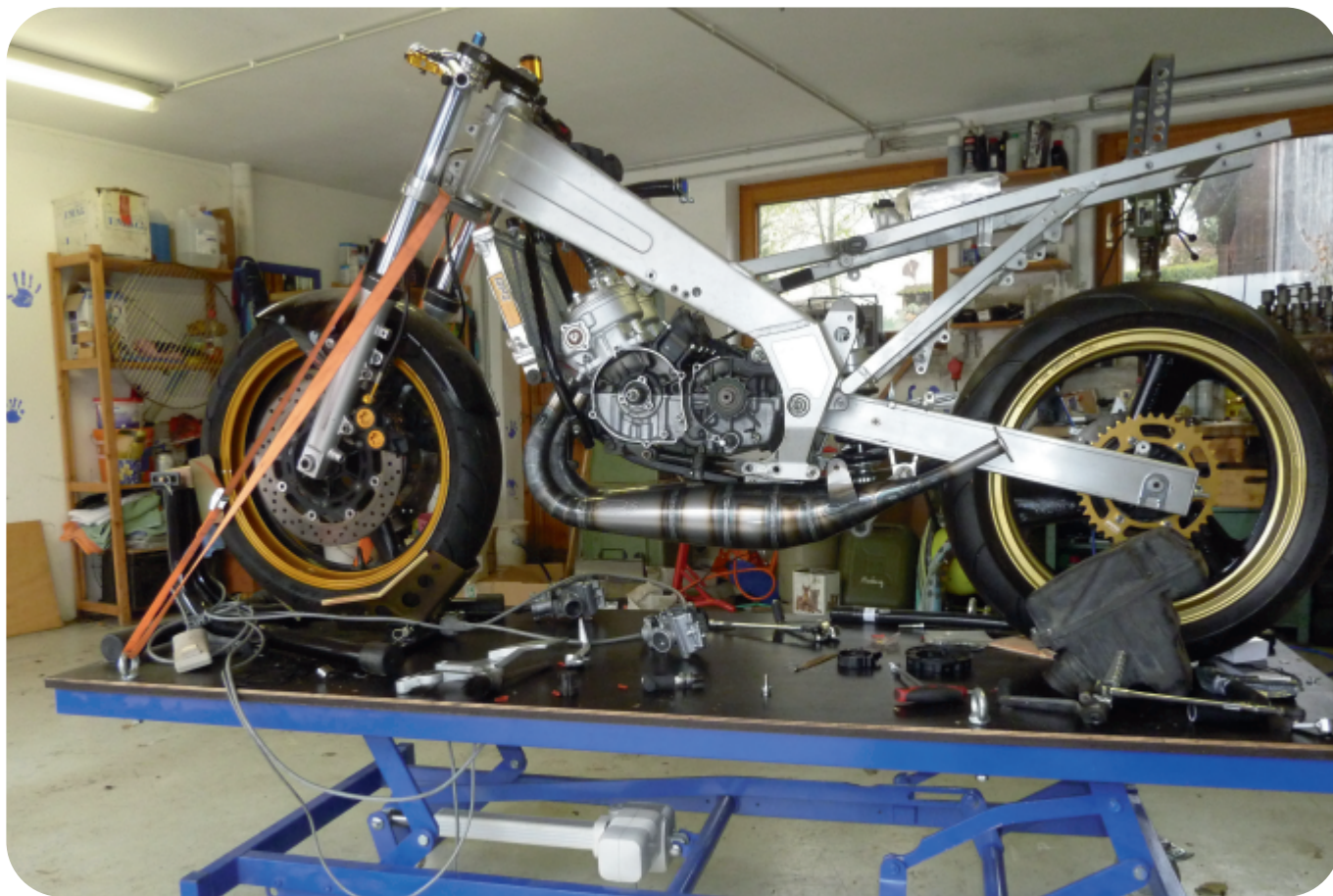
Werners (wwild) TZR250 für die Rennstrecke mit Big-Bore-Kit 360 cm³ und Jolly-Moto-Auspuff
