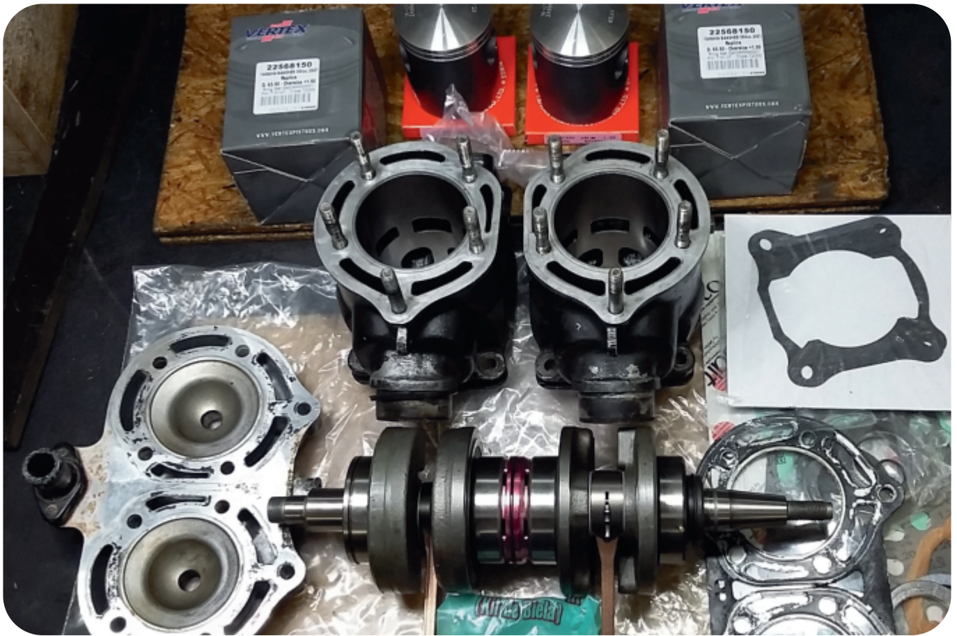
RD350 YPVS Kurbelwelle und Banshee-Zylinder
