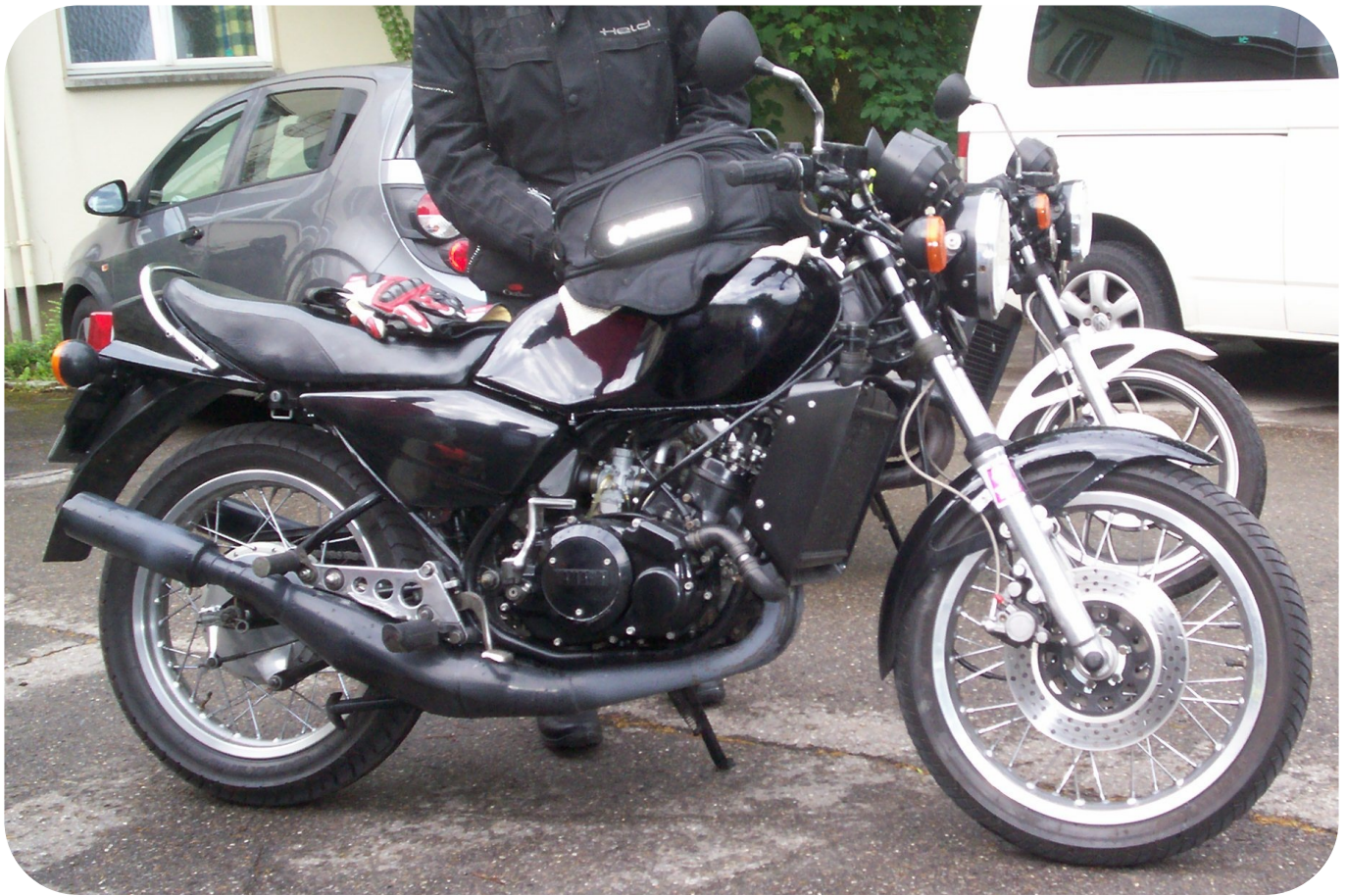
RD350LC (4L0). 31K-Motor mit Banshee-Zylindern. Speichenfelgen.
